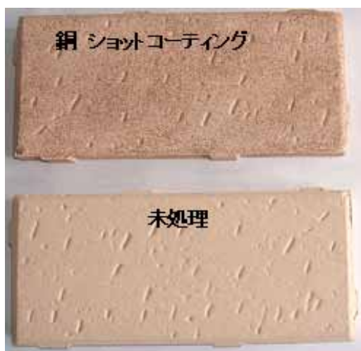
図6 抗菌処理例（保水性建材）
