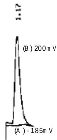
図6 白金黒充填カラム通過後のビタミン K_3 の酸化電流の測定チャート
