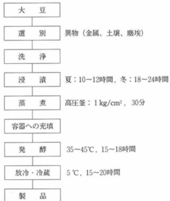
図1 糸引き納豆の製造工程
