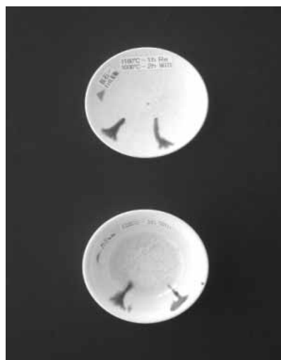
写真4 小皿と小碗による釉の流下状況
