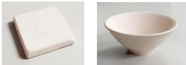
図2 平面テストピース(左側) 器型テストピース(右側)
