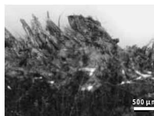
図6 未粉碎繊維から調製した成形物の破断面の様子
