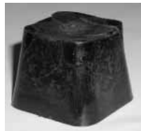
図4 含水率の異なるイエローポプラの蒸気処理木粉の注入成形結果
