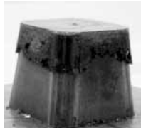
図5 含水率の異なるスギ心材の蒸気処理木粉の注入成形結果
