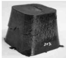
図3 含水率の異なるブナの蒸気処理木粉の注入成形結果
