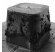
図5 含水率の異なるスギ心材の蒸気処理木粉の注入成形結果
