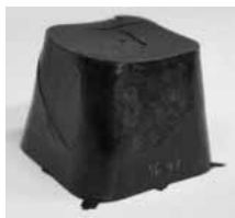
図3 含水率の異なるブナの蒸気処理木粉の注入成形結果
