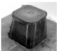
図5 含水率の異なるスギ心材の蒸気処理木粉の注入成形結果
