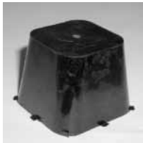
図4 含水率の異なるイエローポプラの蒸気処理木粉の注入成形結果
