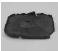
図3 含水率の異なるブナの蒸気処理木粉の注入成形結果
