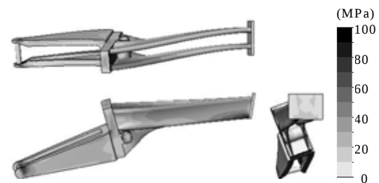
図4 非対称荷重条件における解析結果（応力分布）
