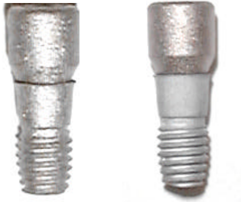
未処理品 HAPコーティング品 写真5 HAPショットコーティング例
