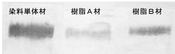
図4 湿潤摩擦による摩擦用白綿布の汚染状態
