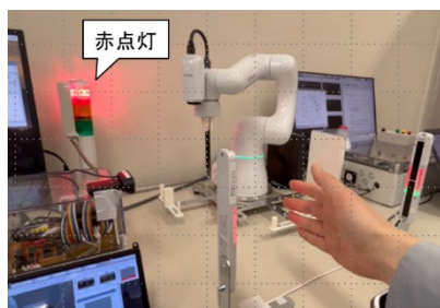
図5 エリアセンサによる表示灯の制御(赤点灯)
