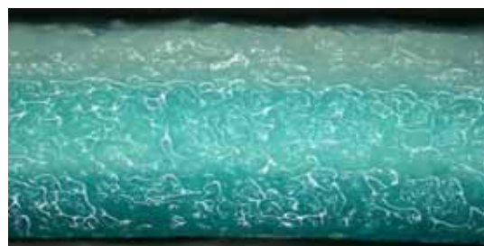
図6 三層多孔体（傾斜構造）の断面 (上：PCL 中：PCL/ケラチン 下：ケラチン)
