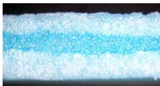
図 5 三層多孔体 (対象構造) の断面 (上下:PCL 中:ケラチン)
