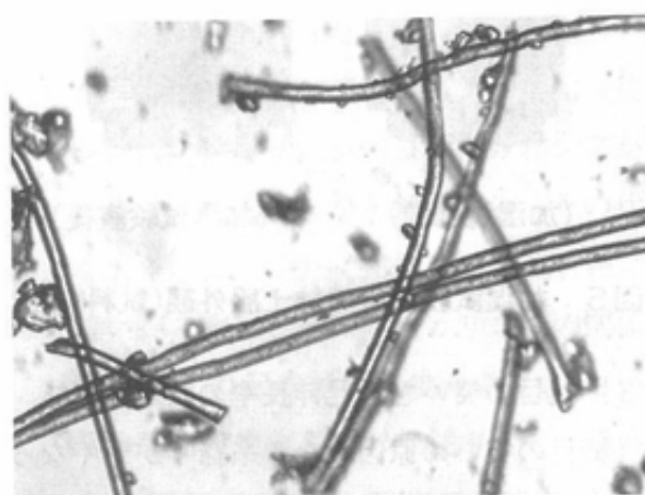
図10 水中に分散したDBPCの状態
