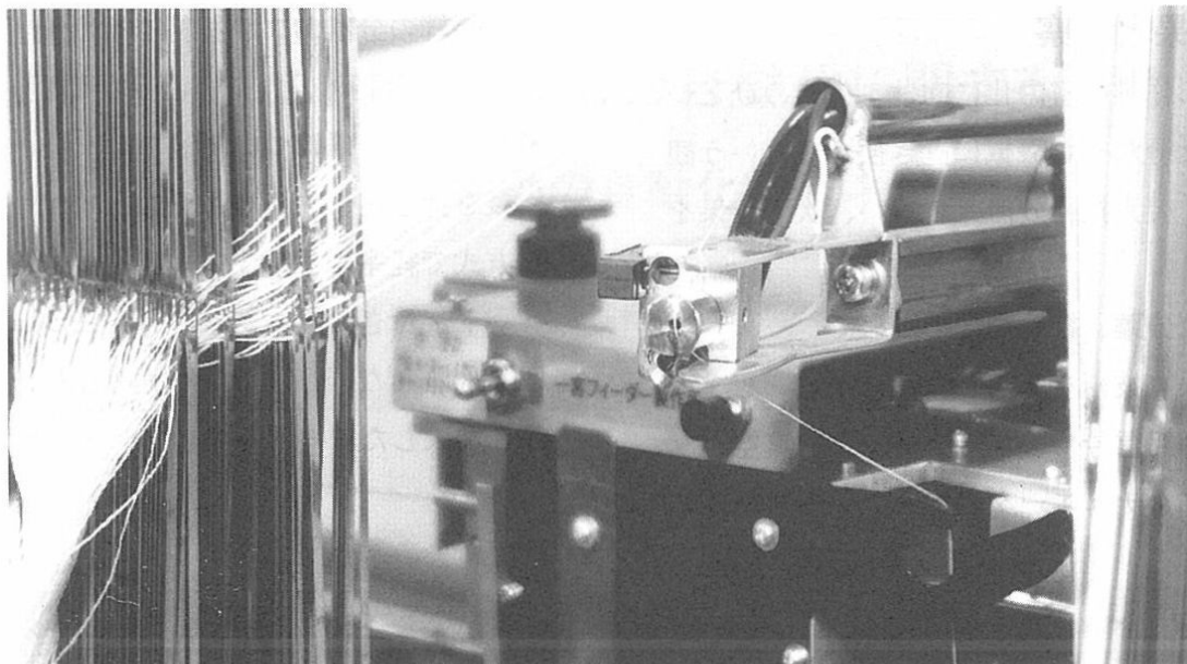
写真8 経糸をリニア機構で送り出す
