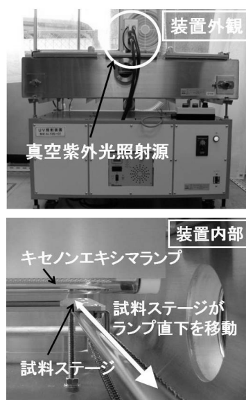
図1 VUV 照射装置
