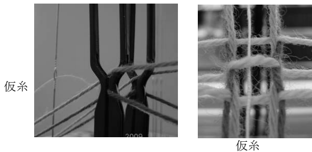
図 13 仮糸の織り込み方法（モデル）
