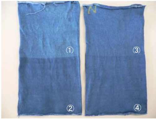
図6 編地で処理した場合の染色性
