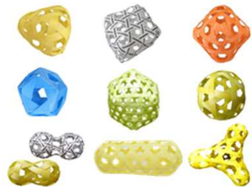
図4 三軸織物と凸多面体
