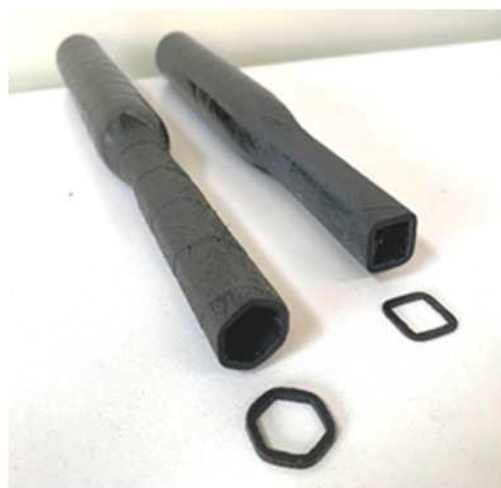
図2 断面形状を変えたCFRTPパイプ (左:六角形断面、右:四角形断面)
