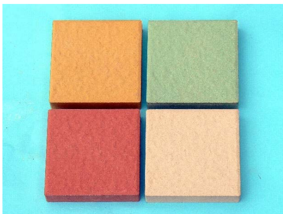
試作したヒートアイランド対策用保水建材
