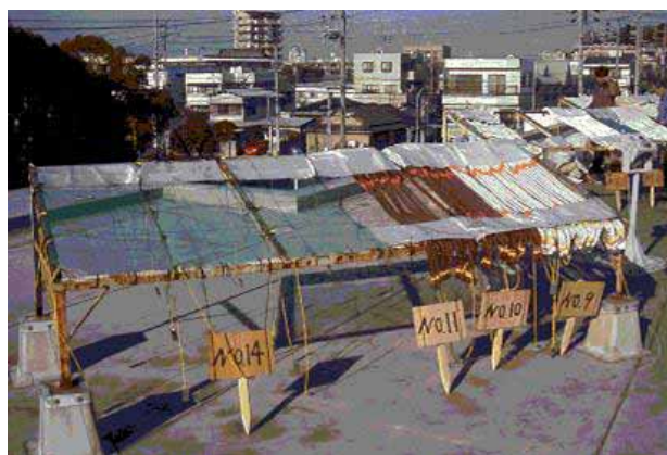
図2 屋外暴露状況
