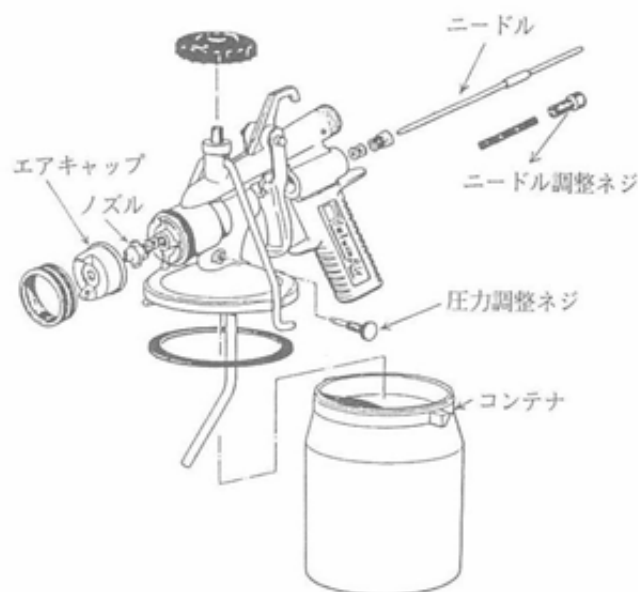
図1 スプレーガンの構造
