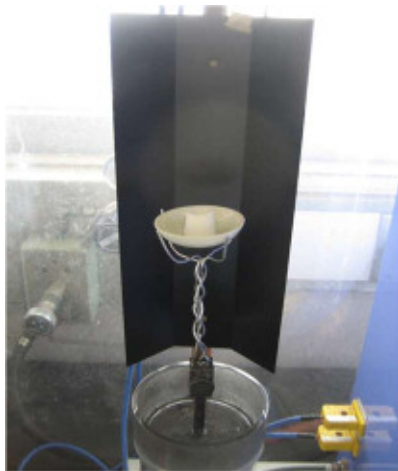
図 3 灰皿を用いた試験治具
