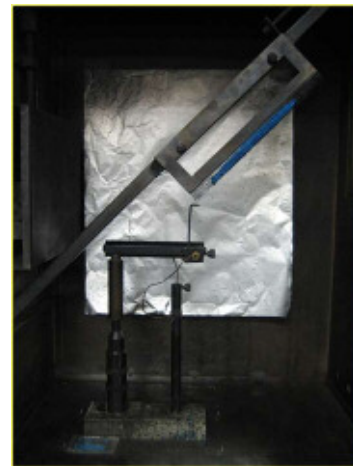
図 5 試験片の支持方法(45°コイル法)
