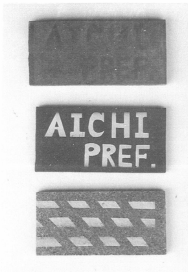
写真5 マスキングによるキャラクタロゴの溶射 (上段：チタニア、中・下段：グレーアルミナ)
