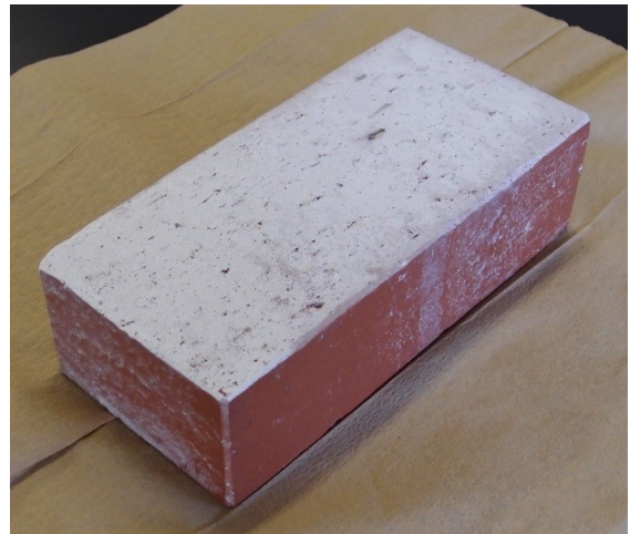
図5 縁加工(1段研削)したれんが全形の浸漬処理結果
