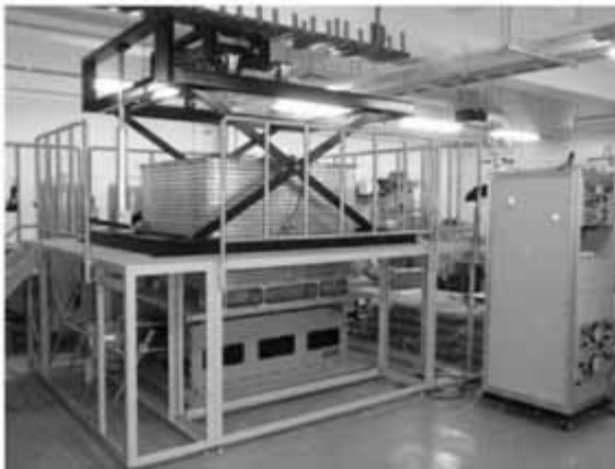
図2 地盤振動装置
