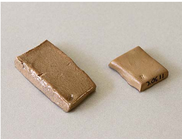
図2 炭酸ナトリウム添加テストピース (左 5%、右 2%)
