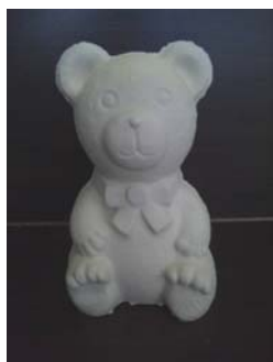
図2 試作鑄込み成型体 (1150℃)
