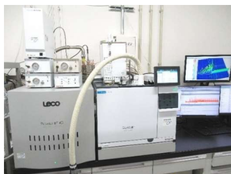
新たに導入した GC×GC-TOF MS の外観
